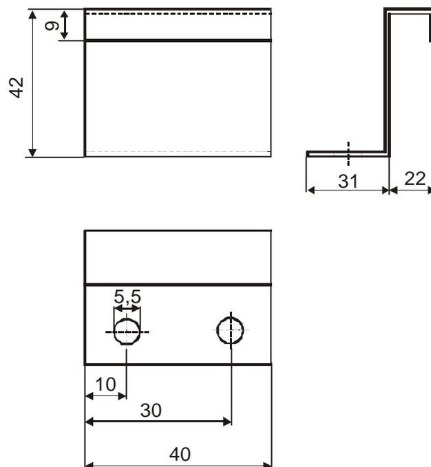
Figura 5.5: Dimensioni del profilo di supporto per il vetro.
