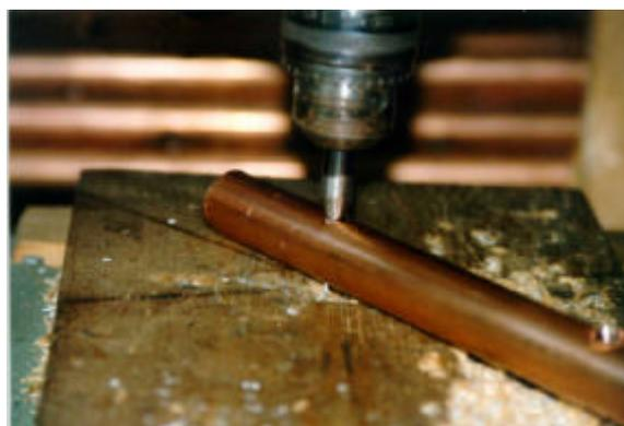
Figura 4.6: Ampliamento del foro sul tubo di raccolta mediante uno strumento particolare.
