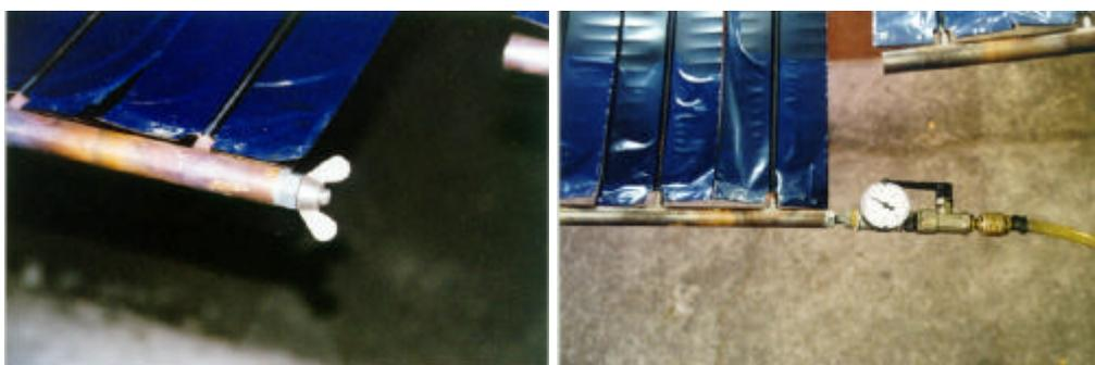
*Figura 4.11: Prova della tenuta a pressione del collettore.*
