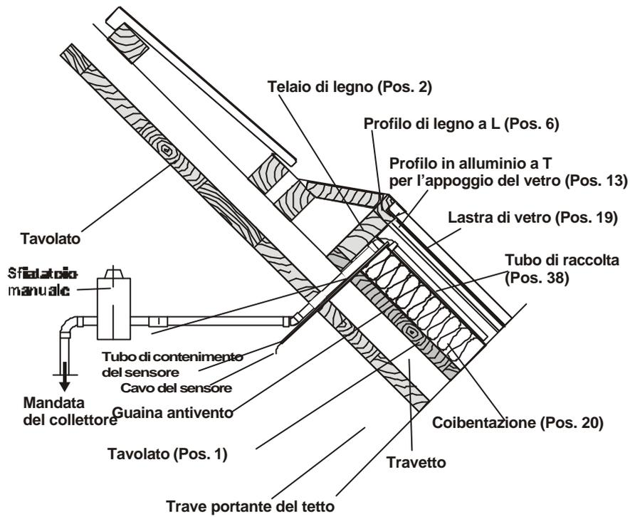
Figura 3.3: Sezione C-C
