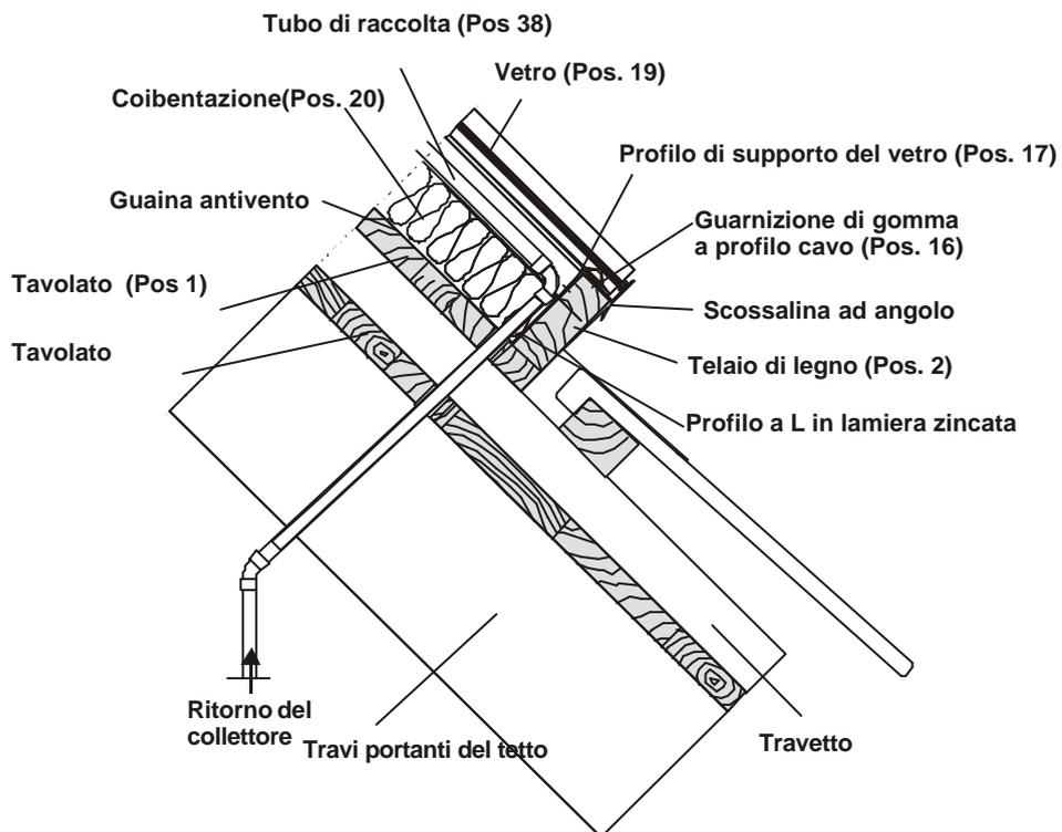
Figura 3.4: Sezione B-B
