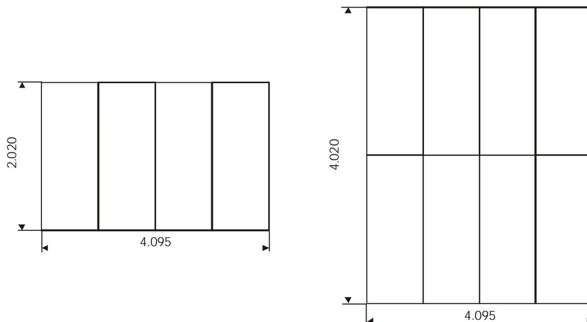
Figura 2.1: Collettore 1 x 4 (quattro vetri affiancati) e collettore 2 x 4 (due vetri sovrapposti e quattro vetri affiancati) – quote in mm.
