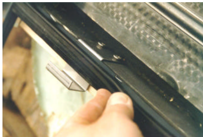
Figura 5.11: Il gommino inferiore cavo viene incollato.
