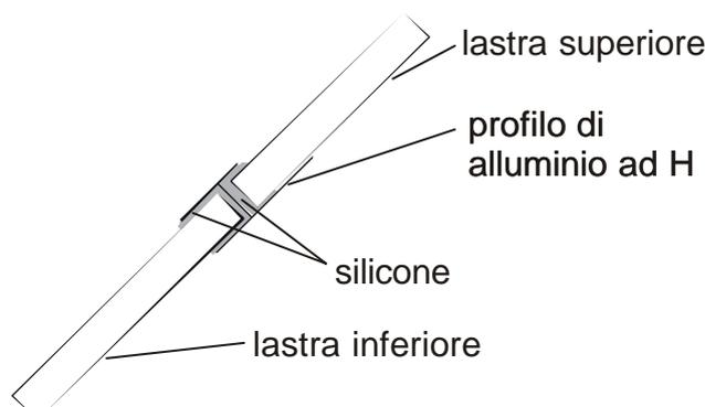
*Figura 5.13: Montaggio del profilo di alluminio ad H che funge da portavetro.*
