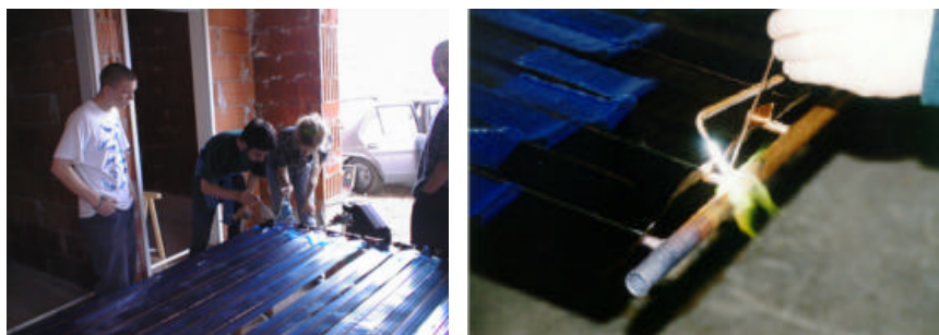
Figura 4.10: Saldatura dolce (sinistra) e saldatura forte (destra) delle strisce di assorbimento
